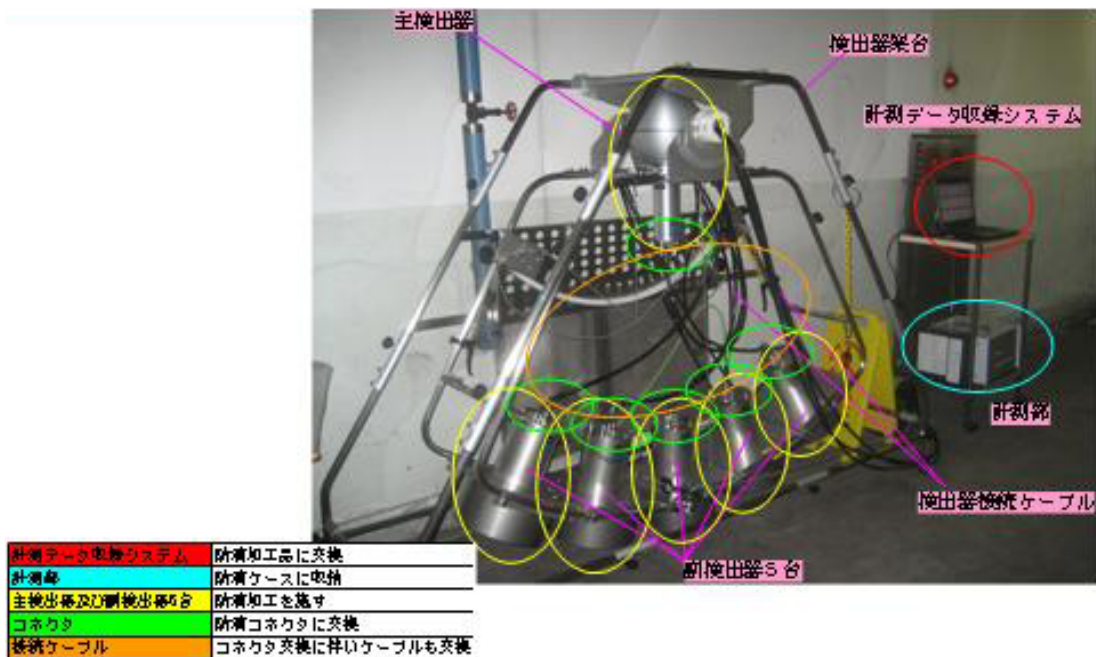
写真－1 計測機器 防滴改良箇所
